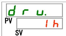
本製品の運転積算時間を表示します。表示は表 5.5-2 を参照してください。
