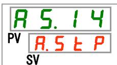
27. [▲]キー及び[▼]キーで接点入力信号 2 検知の切り換えを選択し「SEL」キーで確定してください。
