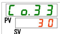
67. [▲]キー及び[▼]キーで下表から応答遅延時間(MODBUS)を選択し「SEL」キーで確定してください。
