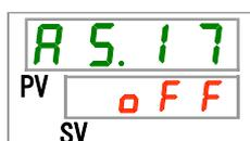
29. [▲]キー及び[▼]キーで下表から電気抵抗/伝導率上昇の切り替えを選択し「SEL」キーで確定してください。
