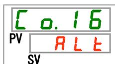
**32.** [▲]キー及び[▼]キーで接点入力信号1形態を選択し「SEL」キーで確定してください。
