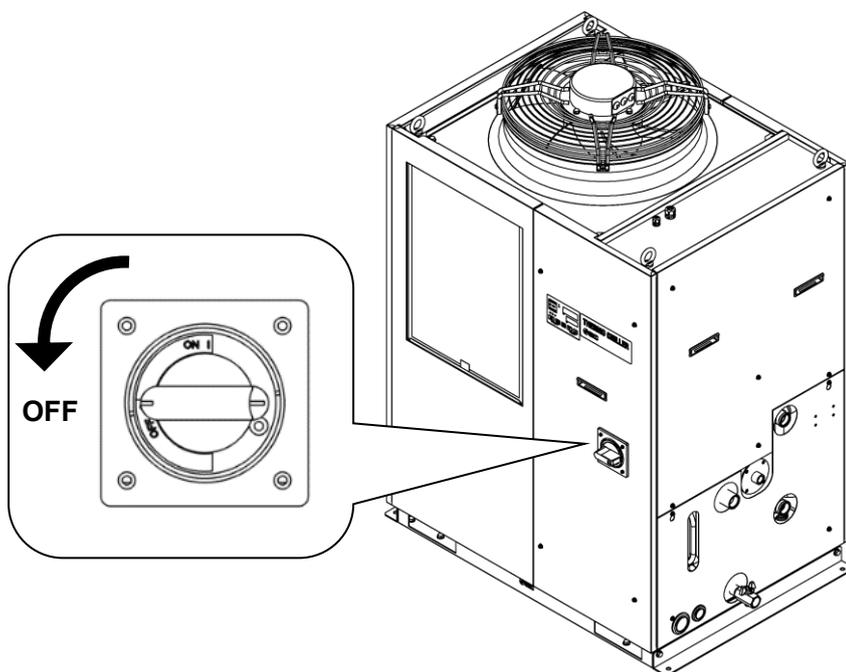
図 1-4 電源スイッチ設置場所
