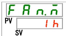
本製品のファン動作積算時間を表示します。表示は表 5.5-2 を参照してください。
