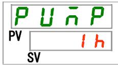
本製品のポンプ動作積算時間を表示します。表示は下表を参照してください。
