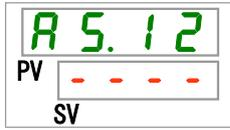
23.[▲]キー及び[▼]キーで通信エラーの監視時間を設定し「SEL」キーで確定してください。
