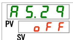
**47.** [▲]キー及び[▼]キーで防塵フィルタメンテナンスの切り換えを選択し「SEL」キーで確定してください。
