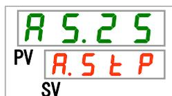
**39.** [▲]キー及び[▼]キーで循環液吐出圧力センサ異常の切り替えを選択し「SEL」キーで確定してください。
