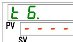
本製品の放熱水入口側の温度を表示します。
