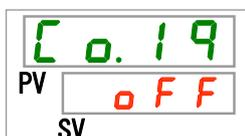
38. [▲]キー及び[▼]キーで接点入力信号2を選択し「SEL」キーで確定してください。
