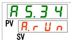
**57.** [▲]キー及び[▼]キーで下表から放熱水出口温度の切り替えを選択し「SEL」キーで確定してください。
