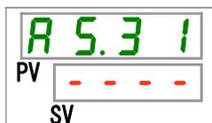
**51.** [▲]キー及び[▼]キーで防塵フィルタメンテナンスの監視時間を設定し「SEL」キーで確定してください。
