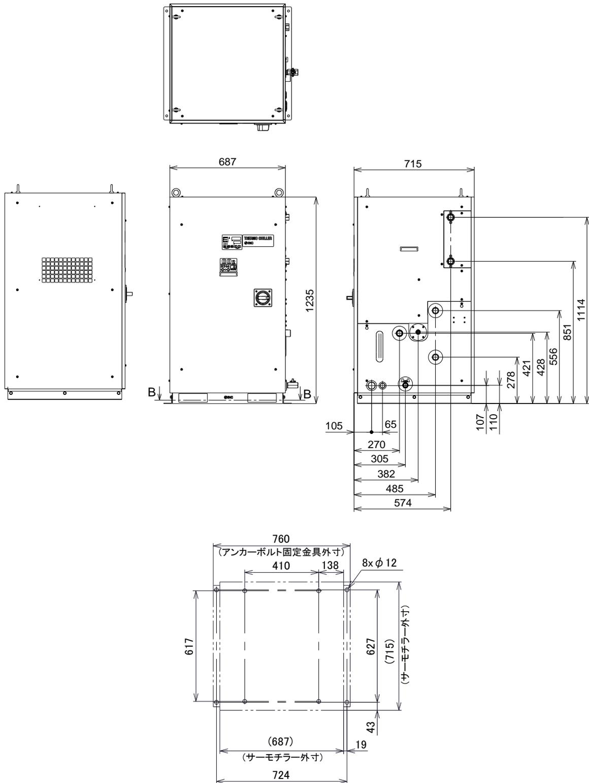
アンカーボルト固定位置(断面図 B-B)
