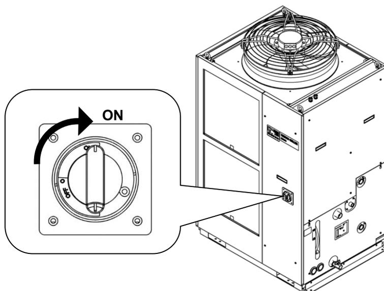
図 4-1 漏電ブレーカ設置場所(本図は型式「HRSC100-A-40」の場合です。)
