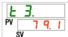
本製品の冷凍機吸込の温度を表示します。
