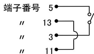
図 3-11 運転/停止信号入力・リモート信号入力の配線(一例)
