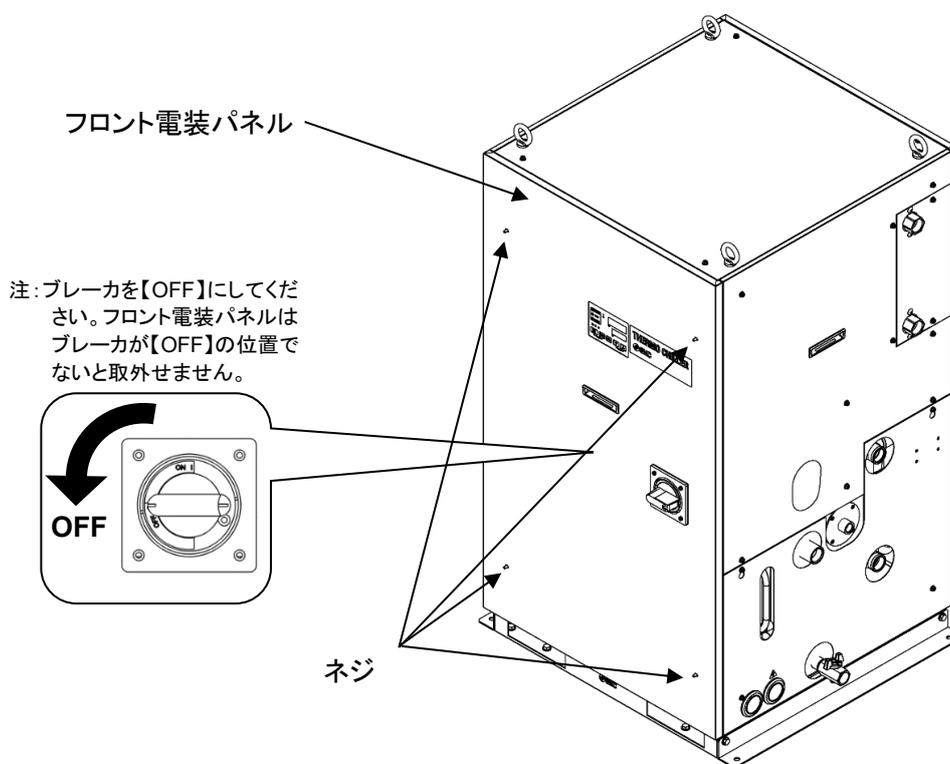
図 3-7 フロント電装パネル取外し(水冷冷凍式の場合)
