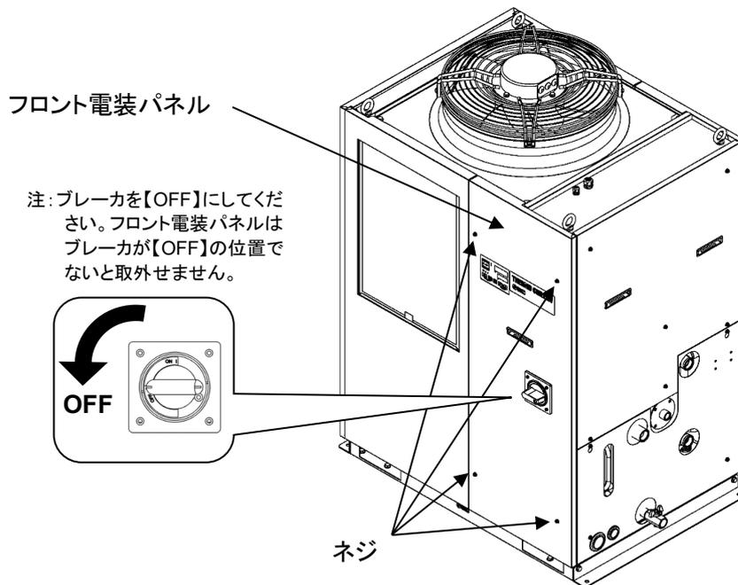
図 3-6 フロント電装パネル取外し(空冷冷凍式の場合)
