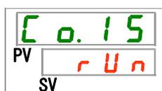
30. [▲]キー及び[▼]キーで接点入力信号1を選択し「SEL」キーで確定してください。
