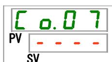
14. [▲]キー及び[▼]キーでデバイスアドレス(簡易通信プロトコル)を選択し「SEL」キーで確定してください。
