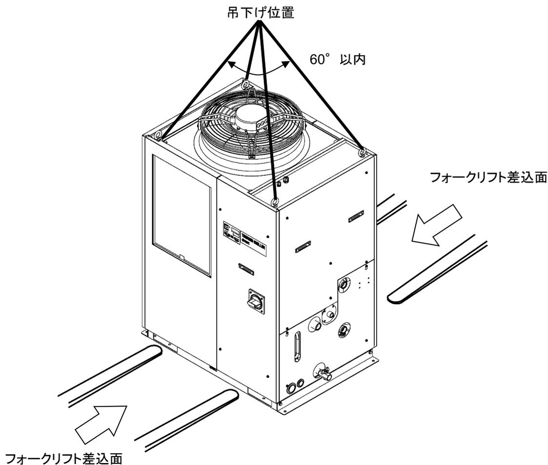
図 3-1 フォークリフトの差込み位置および吊下げ方法(本図は型式「HRSC100-A-40」です。)
