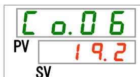
12. [▲]キー及び[▼]キーで通信速度(MODBUS)を選択し「SEL」キーで確定してください。
