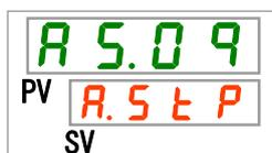
**17.** [▲]キー及び[▼]キーで循環液吐出圧力低下の切り替えを選択し「SEL」キーで確定してください。
