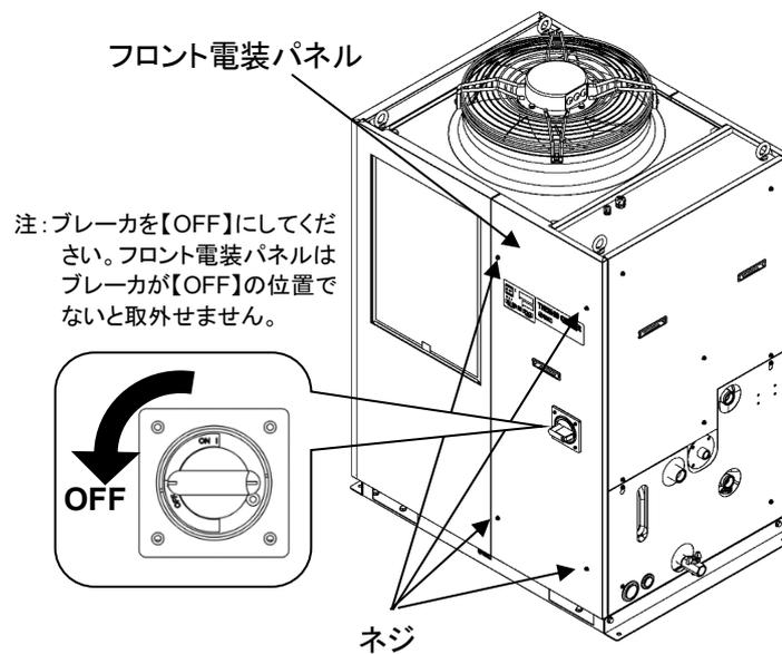
図 6-1 フロント電装パネル取外し
