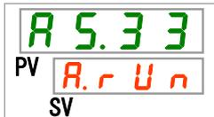
**55.** [▲]キー及び[▼]キーで下表から放熱水入口温度の切り替えを選択し「SEL」キーで確定してください。
