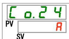
48. [▲]キー及び[▼]キーで接点出力信号1動作を選択し「SEL」キーで確定してください。
