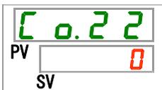
44. [▲]キー及び[▼]キーで接点入力信号 2 OFF 検出タイマの時間を設定し「SEL」キーで確定してください。
