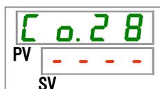
56. [▲]キー及び[▼]キーで接点出力2選択アラームを選択し「SEL」キーで確定してください。
