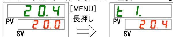
本製品からお客様装置へ送水する循環液吐出口の温度を表示します。オフセット温度は考慮していない温度になっています。
