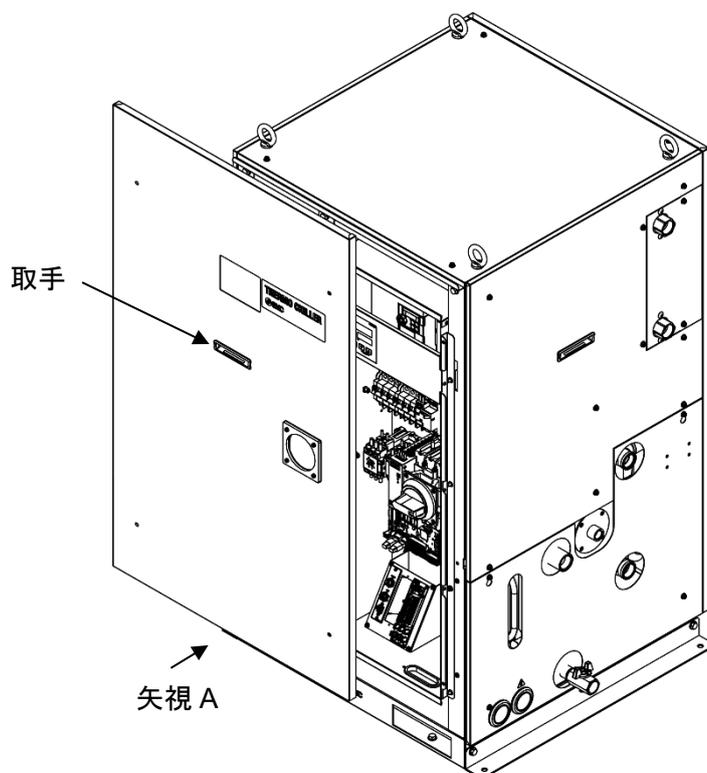
図 3-9 フロント電装パネル取外し(水冷冷凍式の場合)
