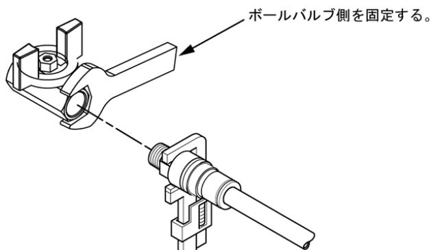
図 3-17 ドレン口への配管接続方法
