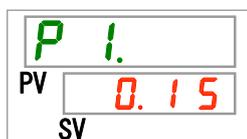
本製品からお客様装置へ送水する循環液吐出口の圧力を表示します。
