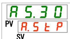
**49.** [▲]キー及び[▼]キーで停電復帰の切り換えを選択し「SEL」キーで確定してください。
