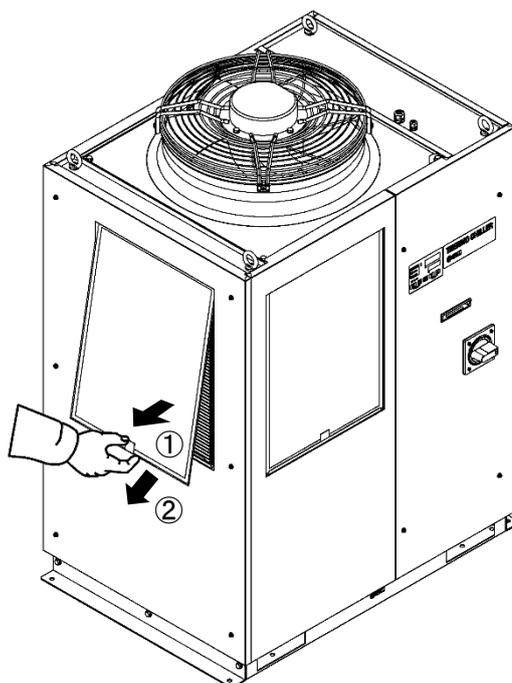
図 7-1 防塵フィルタ取外し
