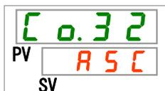
65. [▲]キー及び[▼]キーで下表から伝送モード(MODBUS)を選択し「SEL」キーで確定してください。
