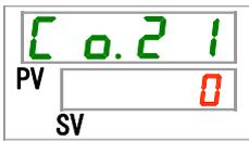
42. [▲]キー及び[▼]キーで接点入力信号2読み込みデレータイマの時間を設定し「SEL」キーで確定してください。
