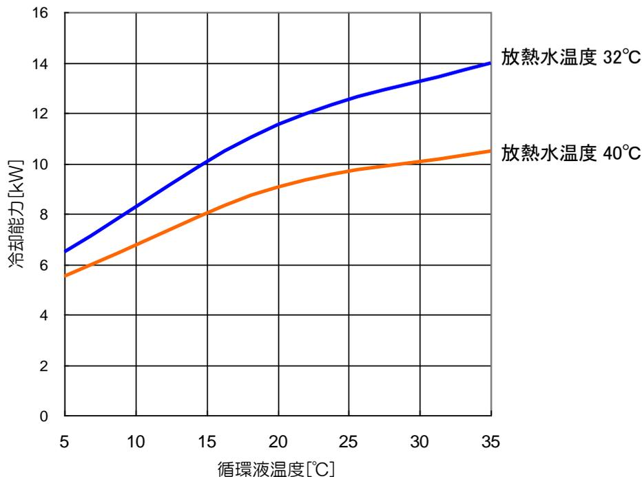
図 8-6 冷却能力(HRSC100-W※-40)
