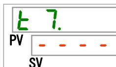
本製品の放熱水出口側の温度を表示します。
