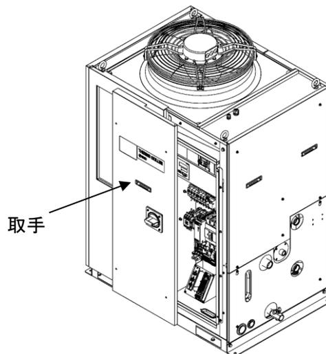
図 6-2 フロント電装パネル取外し
