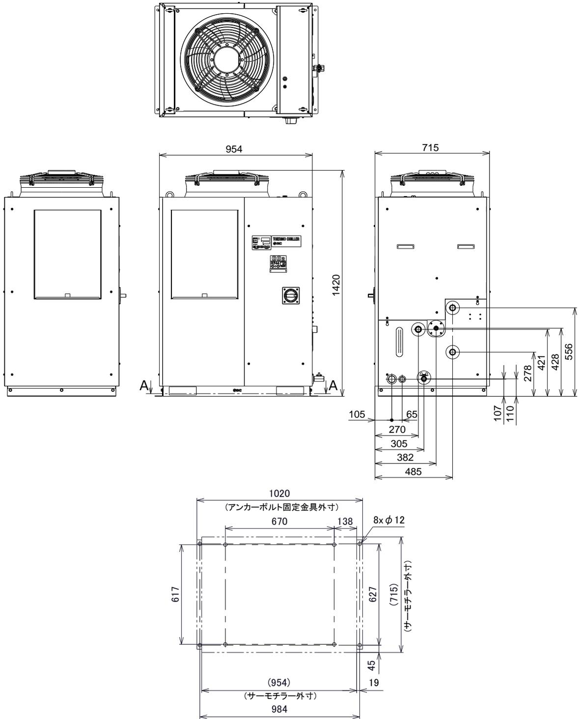
アンカーボルト固定位置(断面図 A-A)
