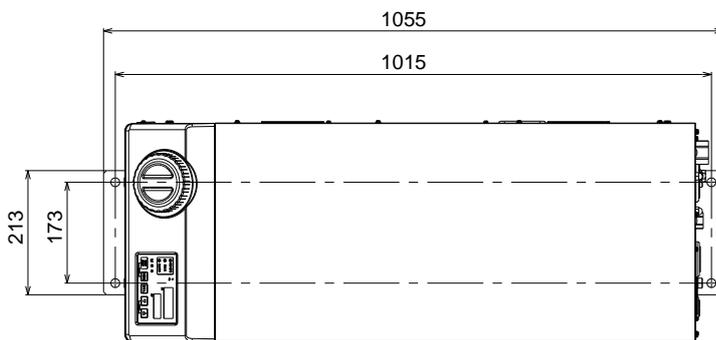
図 9.2-4 アンカーボルト取付位置外形寸法図
