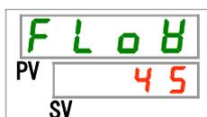
本製品の循環液流量(目安)を表示します。単位は「L/min」となります。
