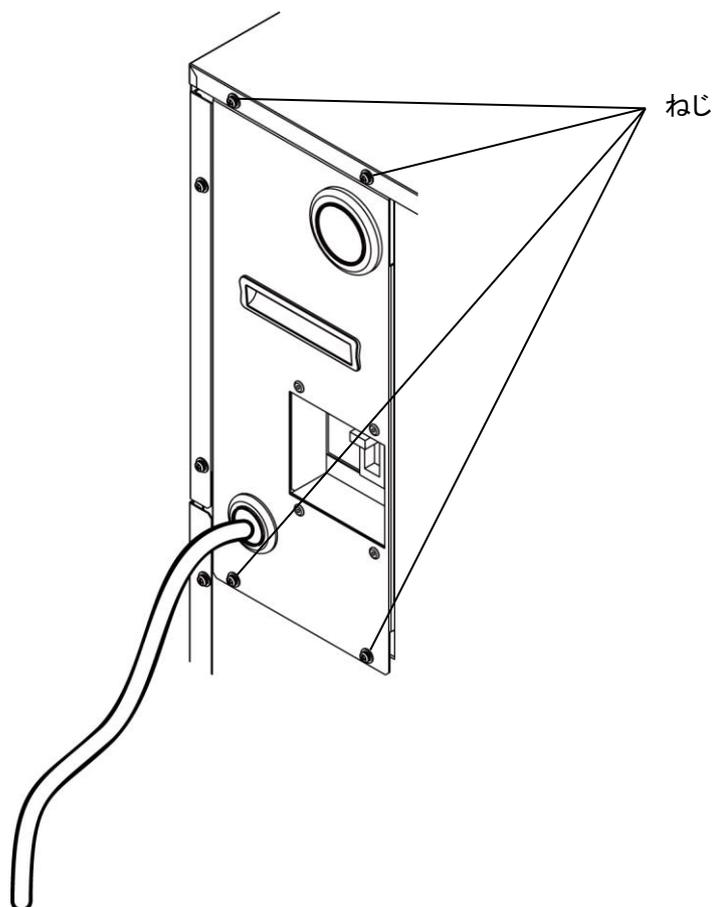
図 3.3-9 電源端子カバー取付け
