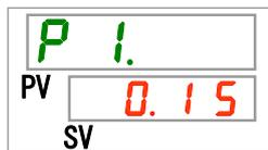
本製品からお客様装置へ送水する循環液吐出口の圧力を表示します。
