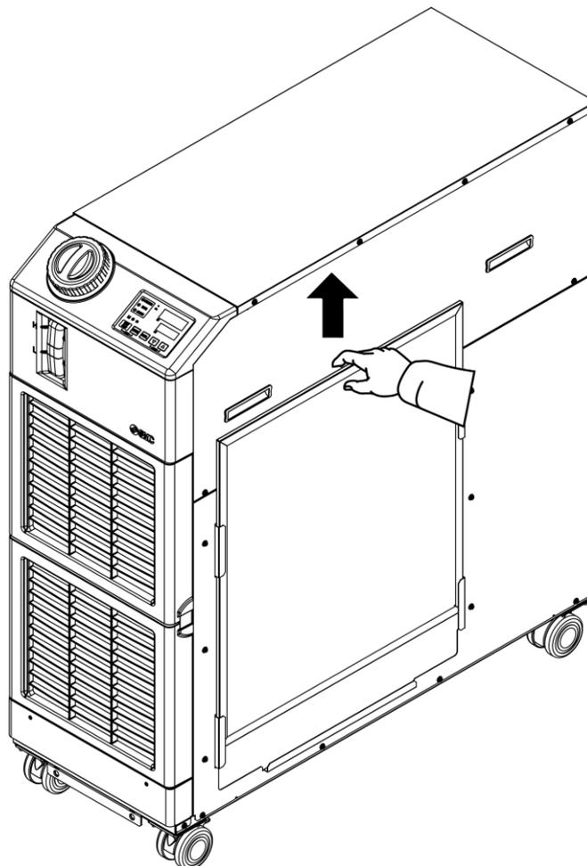
図 8.2-1 防塵フィルタ取外し
