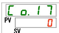
34. [▲]キー及び[▼]キーで接点入力信号 1 読み込みディレータイマの時間を設定し「SEL」キーで確定してください。
