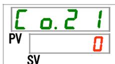
42. [▲]キー及び[▼]キーで下表から接点入力信号 2 読み込みデレータイマの時間を設定し「SEL」キーで確定してください。
