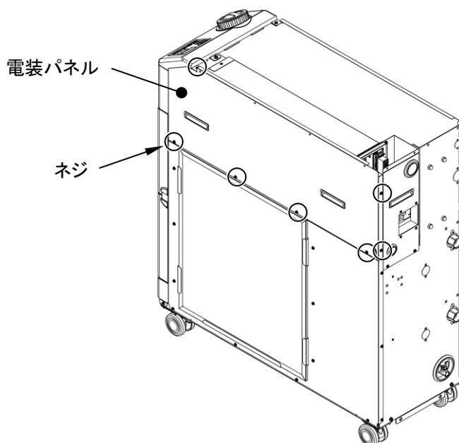
図 7.3-2 電装パネル取外し
