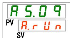
**17.** [▲]キー及び[▼]キーで下表から循環液吐出圧力低下の切り替えを選択し「SEL」キーで確定してください。
