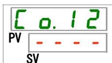
**24.**[▲]キー及び[▼]キーで下表からストップビット(簡易通信プロトコル)を選択し「SEL」キーで確定してください。
