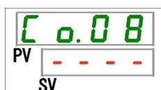
16. [▲]キー及び[▼]キーで下表から通信速度(簡易通信プロトコル)を選択し「SEL」キーで確定してください。
