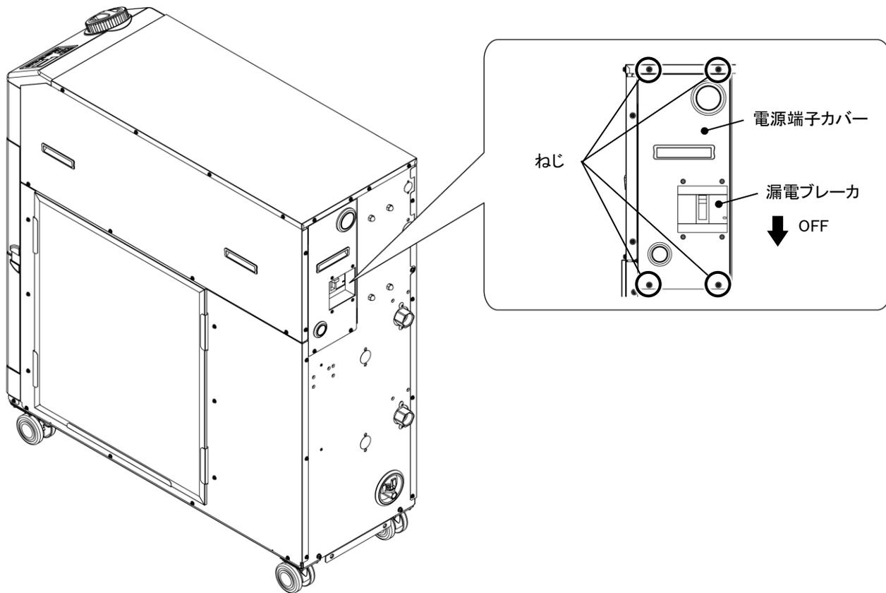
図 3.3-5 電源端子カバー取外し
