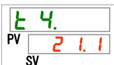
本製品の冷凍機吸込口の温度を表示します。
