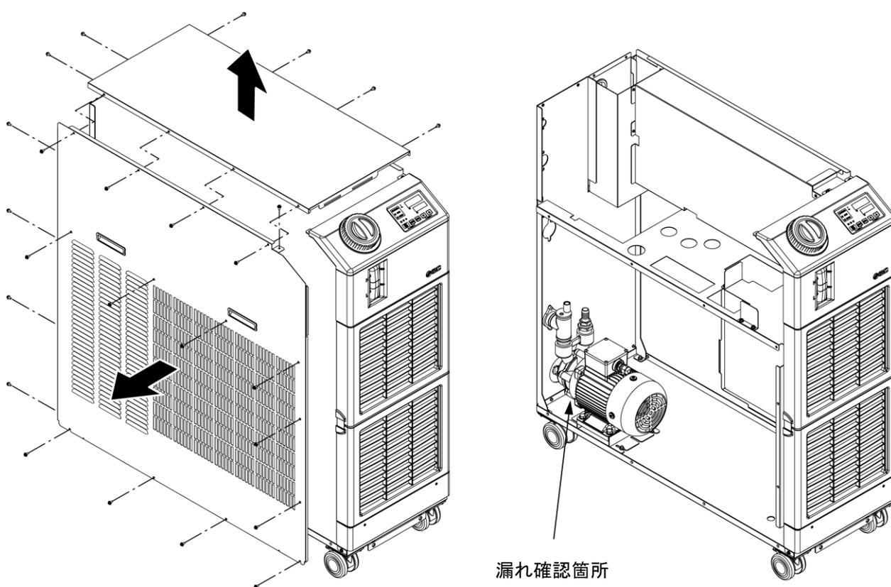
図 8.2-3 ポンプからの水漏れ点検
