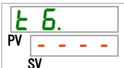
本製品の放熱水入口側の温度を表示します。
