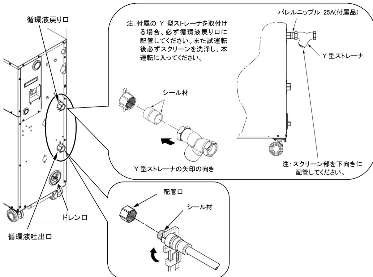
図 3.4-1 配管締め込み
