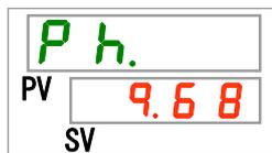
本製品の冷媒回路高圧側の圧力を表示します。
