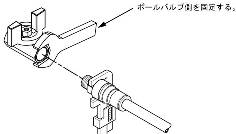
図 8.4-2 ドレン口への配管接続方法
