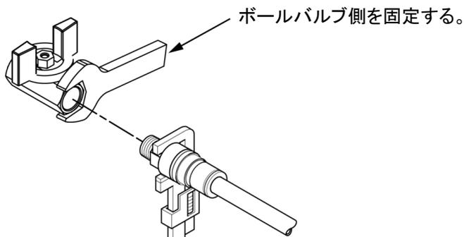
図 3.4-2 ドレン口への配管接続方法
