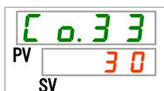
66. [▲]キー及び[▼]キーで下表から応答遅延時間(MODBUS)を選択し「SEL」キーで確定してください。
