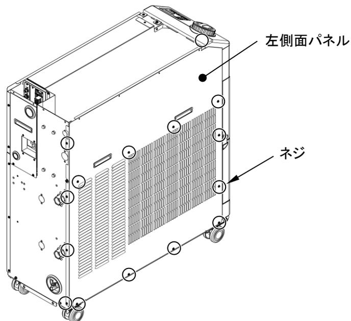
図 7.3-5 左側面パネル取外し
