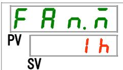
本製品のファンモータ動作積算時間を表示します。表示は表 5.5-2 を参照してください。
