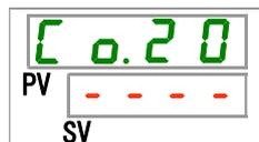
40. [▲]キー及び[▼]キーで下表から接点入力信号 2 形態を選択し「SEL」キーで確定してください。
