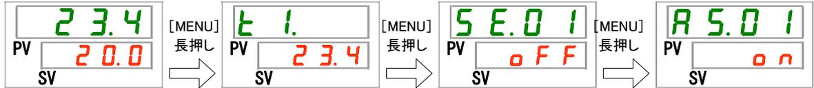
タンク液面低下の切り替え 設定・確認
