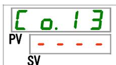
**26.**[▲]キー及び[▼]キーで下表から応答遅延時間(簡易通信プロトコル)を選択し「SEL」キーで確定してください。
