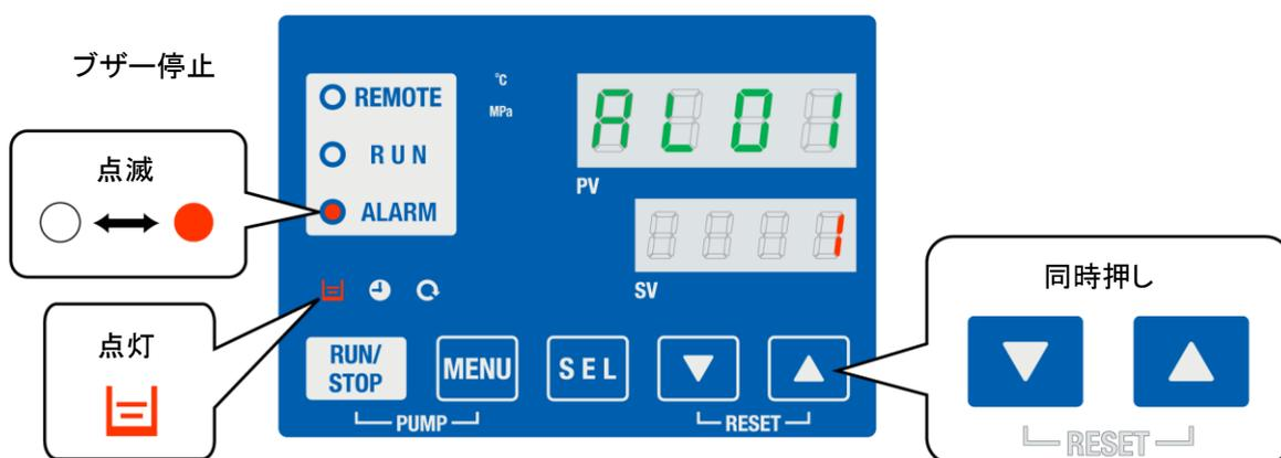
※AL01 タンク液面低下の場合のみ[≡]ランプが点灯します。
