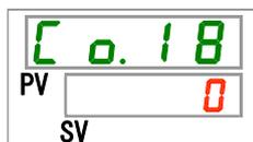
36. [▲]キー及び[▼]キーで接点入力信号 1 OFF 検出タイマの時間を設定し「SEL」キーで確定してください。
