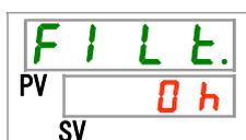
本製品の防塵フィルタ積算時間を表示します。表示は表 5.5-2 を参照してください。
