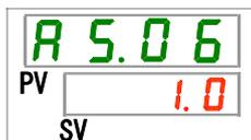
**11.** [▲]キー及び[▼]キーで循環液吐出温度低下の検出温度を設定し「SEL」キーで確定してください。
