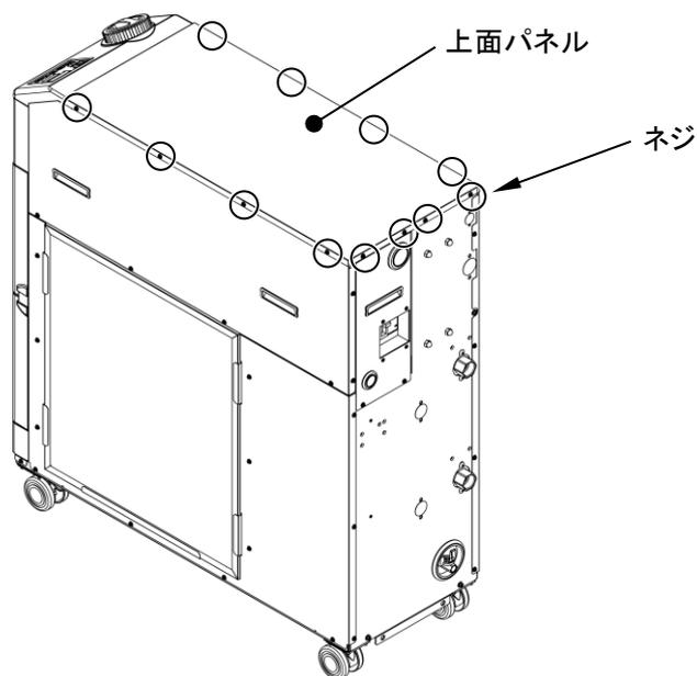
図 7.3-1 上面パネル取外し
