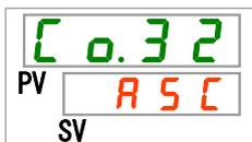
64. [▲]キー及び[▼]キーで下表から伝送モード(MODBUS)を選択し「SEL」キーで確定してください。
