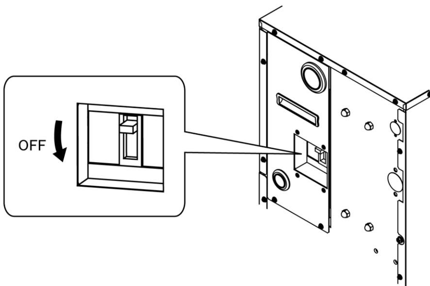
図 1.6-1 電源スイッチ設置場所
