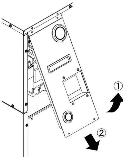
図 3.3-6 電源端子カバー取外し
