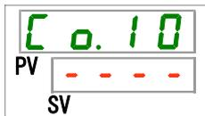
20. [▲]キー及び[▼]キーで下表からデータ長 (簡易通信プロトコル) を選択し「SEL」キーで確定してください。
