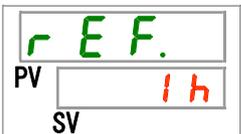
本製品の冷凍機動作積算時間を表示します。表示は表 5.5-2 を参照してください。
