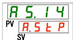
**27.** [▲]キー及び[▼]キーで下表から接点入力信号 2 検知の切り換えを選択し「SEL」キーで確定してください。
