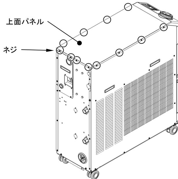
図 7.3-4 上面パネル取外し
