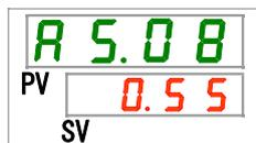
**15.** [▲]キー及び[▼]キーで循環液吐出圧力上昇の検出圧力を設定し「SEL」キーで確定してください。
