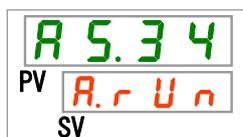
22. [▲]キー及び[▼]キーで下表から放熱水出口温度の切り替えを選択し「SEL」キーで確定してください。
