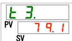
本製品の冷凍機吐出口の温度を表示します。
