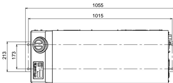
図 9.2-2 アンカーボルト取付位置外形寸法図
