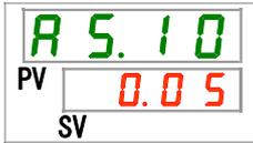
**19.**[▲]キー及び[▼]キーで循環液吐出圧力低下の検出圧力を設定し「SEL」キーで確定してください。
