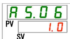
11. [▲]キー及び[▼]キーで下表から循環液吐出温度低下の検出温度を選択し「SEL」キーで確定してください。
