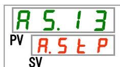
25. [▲]キー及び[▼]キーで下表から接点入力信号1検知の切り換えを選択し「SEL」キーで確定してください。
