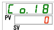
**36.** [▲]キー及び[▼]キーで接点入力信号 1 OFF 検出タイマを選択し「SEL」キーで確定してください。
