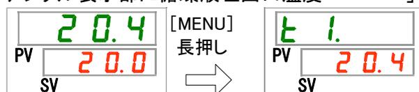
本製品からお客様装置へ送水する循環液吐出口の温度を表示します。オフセット温度は考慮していない温度になっています。
