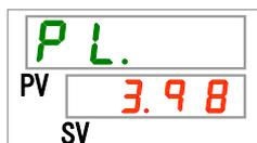
本製品の冷媒回路低圧側の圧力を表示します。
