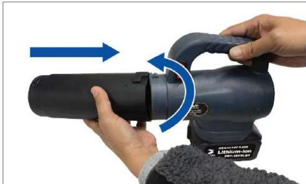
2. ストレートノズルを連結します。左記と同じように差し込んだ後奥側に回して固定します。
