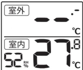
送信機からの電波を遮るものがある場合、また送信機の電池切れの場合、[室外]に左図のような「---」が表示されます。送信機を本体に近づけても温度が表示されないときは、新しい電池に交換してください。
