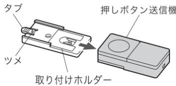
②電池ケースを引き抜き、図のようにCR2032リチウム電池を⊕⊖正しくセットします。
