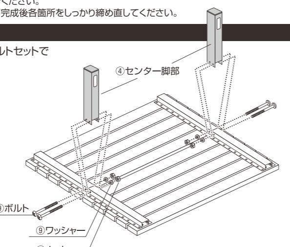
製品の強度を保つために、ボルトナットは固い構造になっています。
