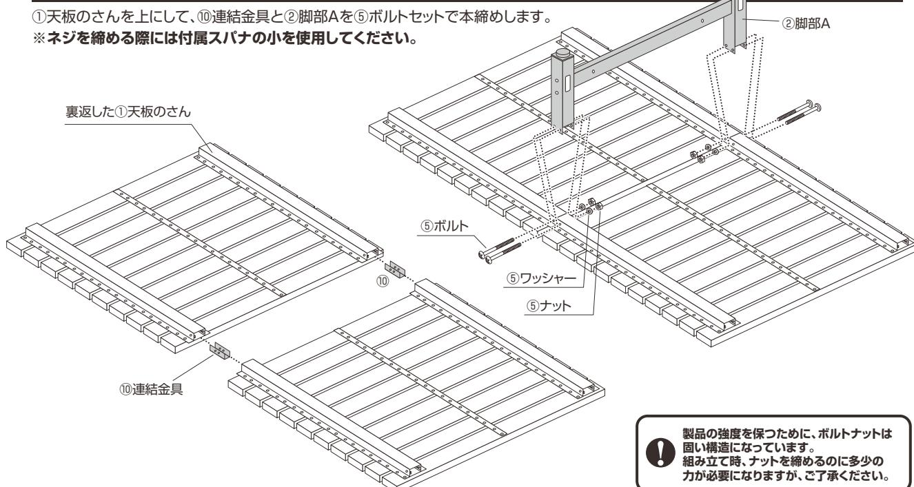
製品の強度を保つために、ボルトナットは固い構造になっています。
