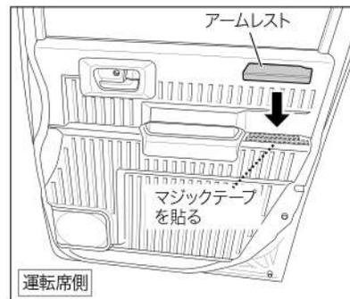
**1** アームレスト装着面をクリーナーで脱脂し、付属のマジックテープを貼り付けてください。
