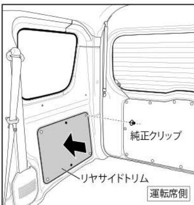
トリムパネルを純正クリップで取付けます。
