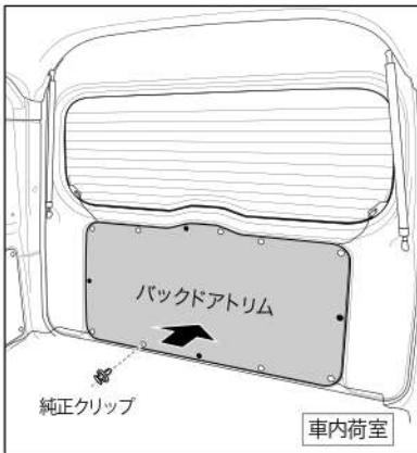
トリムパネルを純正クリップで取付けます。
