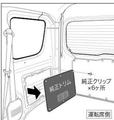
③ ドライバー等固い棒状の物を使って純正トリムを取外します。(下図参照)
