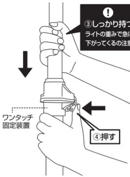
③上部パイプを持ちながら、④ワンタッチボタンを押してください。上部パイプを持たずにワンタッチボタンを押すと、上部パイプが急に落ちてきて大変危険です。
