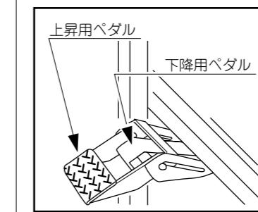
ペダルの踏み込み、戻しは上昇ペダルを伸ばしゆっくり確実に行って下さい。
