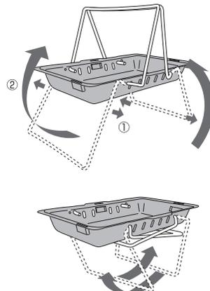
○脚を折り畳む際は、必ず2本同時に動かし、交わる位置で幅の広い脚の内側に幅の狭い脚を通して折り畳んでください。
