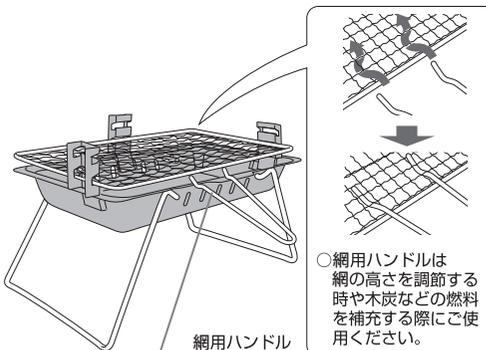
○脚の差し込み部を外側に広げながら外方向へ回転させることで本体の上部で取手として利用することもできます。
