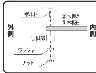
製品の強度を保つために、ボルト・ナットは固い構造になっています。ナットを締めるのに多少の力が必要になりますが、ご了承ください。
