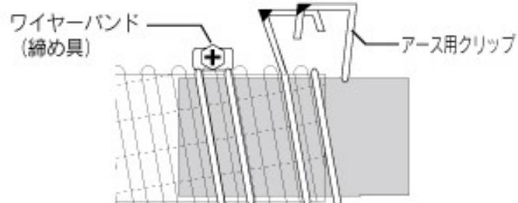
3. アース用クリップの先端をつまみながら、アース用クリップをホースの溝に沿わせて1回転させ取付け完了です。
