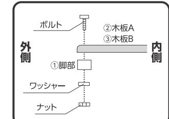
製品の強度を保つために、ボルト・ナットは堅い構造になっています。ナットを締めるのに多少の力が必要になりますが、ご了承ください。
