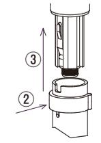
③スイッチをパイプ側に押したままジョイント部分を引き抜く
