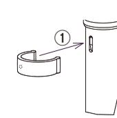
①専用スイッチ内側の凸ビンをパイプ側の長穴部分に合うように取り付ける
