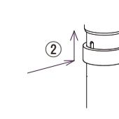
②パイプ側に押しながらジョイント側へスイッチをスライドさせロックを解除
