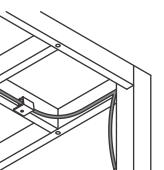
電源コードを固定せずに使用すると、断線やショートを引き起こし、火災や感電、故障の原因になります。
