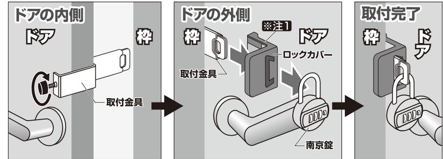
取付金具をドア側面にはめ、ツマミを回してドア側面にしっかり固定し、ドアを閉めるときに取付金具とドア枠が当たらないか確認します。
