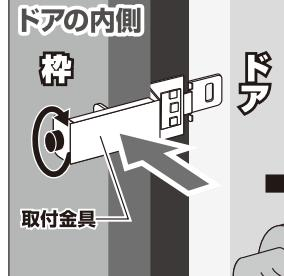
取付金具をドア枠にはめ、ツマミを回してドア枠にしっかりと固定し、ドアを閉めるときに取付金具とドアが当たらないか確認します。
