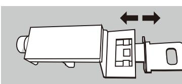
取付金具の先端が稼働しますので、ドア厚み35~40mmまで対応出来ます。(カラー裏面の取付可能寸法をご参照下さい)金具先端のロックカバーを差し込む際は、金具の先端をしっかりと引き出しながらロックカバーを差し込み、南京錠で施錠して下さい。
