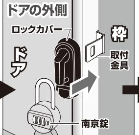
ドアを閉めて、取付金具にロックカバーを差し込み、南京錠を掛けて施錠して下さい。
