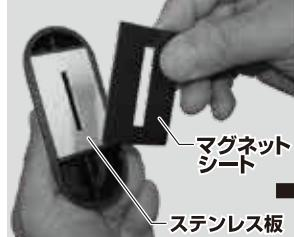
付属のマグネットシートをロックカバーの「ステンレス板面」に剥離紙を剥がして貼ります。中心に合わせて左右均等にキレイに貼って下さい。スペーサーを使用する場合はスペーサーの上から貼って下さい。
