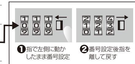
番号を「0・0・0」に合わせて解錠状態にしてダイヤル右側レバーを左に動かしながら(図①)好みの番号に設定します。(番号設定中はレバーは左に動かさないでください。)とレバーが元に戻り、戻った時点での番号に設定されますのでご注意下さい。
