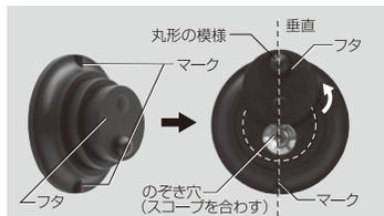
2 裏面の両面テープのはくり紙をはがして、ドアスコープをのぞき穴に合わせて、マークと「フタの中心に並んだ丸形の模様」が垂直になる様、真っ直ぐに貼って下さい。
