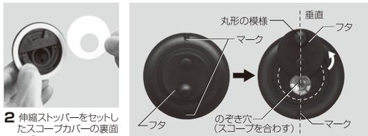
2 拡張ストッパーをセットしたスコープカバーの裏面に「一般スコープ用両面テープ」を片面はくり紙をはがして、貼り付けます。
