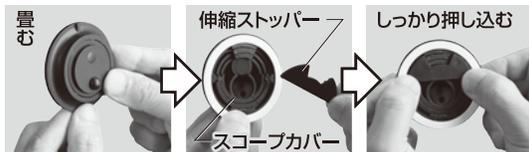
1 スコープカバーを畳んで裏から「拡張ストッパー」の凸のある面を、スコープカバーの溝の部分にあてて「面」になるまで「しっかり押し込んでセットします。
