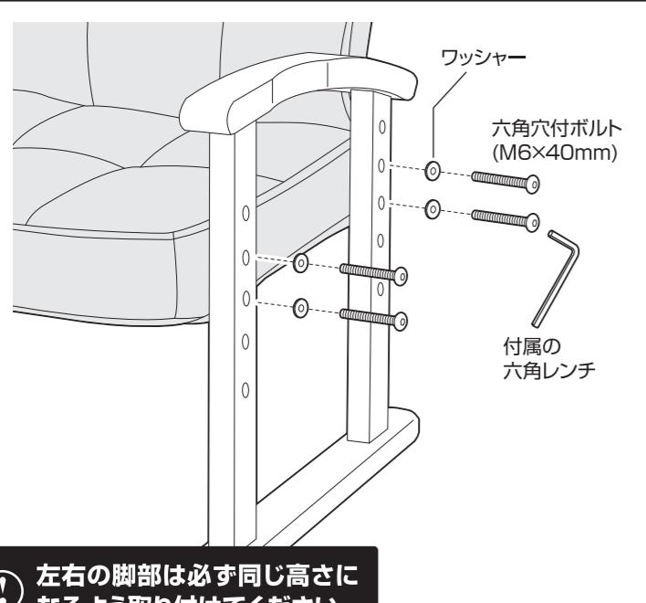
**! 左右の脚部は必ず同じ高さになるよう取り付けてください。**
