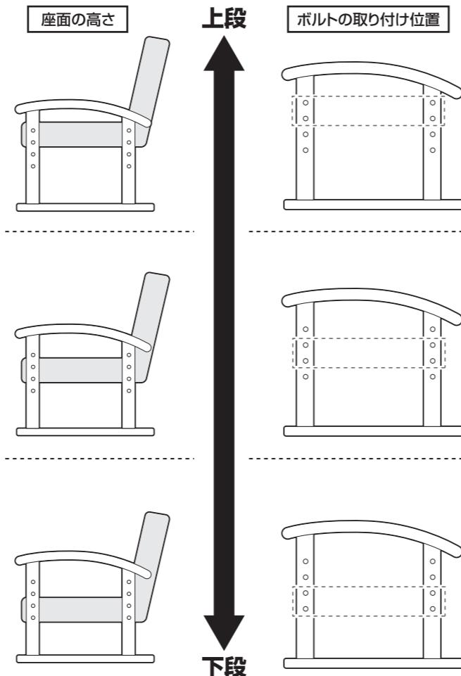
**! 左右の脚部は必ず同じ高さになるよう取り付けてください。**
