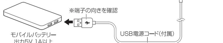
●付属のUSB電源コードは本製品専用です。本製品をご使用の際には必ず付属のUSB電源コードをお使いください。また、付属のUSB電源コードは絶対に他の製品には使用しないでください。製品の破損、もしくは火傷・発煙・火災の原因となる場合があります。
