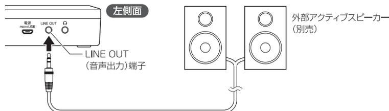
本機の電源が切れている状態で、本機と外部アクティブスピーカー(別売)を上図のように接続してください。
