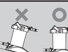
! 必ず下図通りに設置してください。誤って設置しますと、純水器本体に大きな圧力がかかり破裂するおそれがあります。
