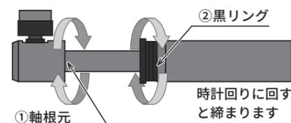
緩くなった場合は、軸および黒リング部を時計回りに手で回し、締め直してお使いください。
