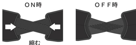
空気を入れると人工筋肉が収縮し、腰を締めつけます。締めつけ感、人工筋肉に入れる空気量で調節できます。
