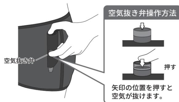
空気抜き弁操作方法
