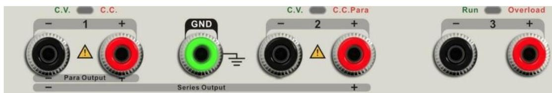
CH1、CH2、およびCH3の出力端子には各モードで使用される端子についての記述があります。直列モード (Series Output)はCH1のマイナス端子とCH2のプラス端子を使い、並列モード (Para Output)はCH1のプラス端子とマイナス端子を使用します。GND端子は電源コネクタから取れるアース端子と接続されています。CH1~CH3の各プラス端子とマイナス端子はフローティングされ、GNDとは接続されていません。操作の詳細は、次の「コントロールパネルの操作」のセクションで紹介されています。
