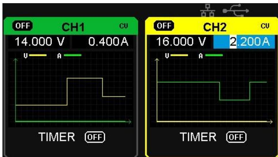
注：黄色い線は電圧を表し、緑色の線は電流を表し、Y軸は相対的な電圧または電流値（0～32V / 0～3.2A）を表します。
