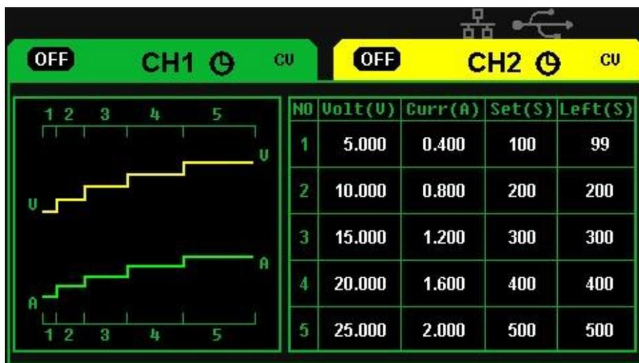
タイマー作動中に「On / Off」ボタンを押して出力をオフにすると、カウントダウンは停止します。チャンネル出力が再びオンになると、カウントダウンが再開されます。
