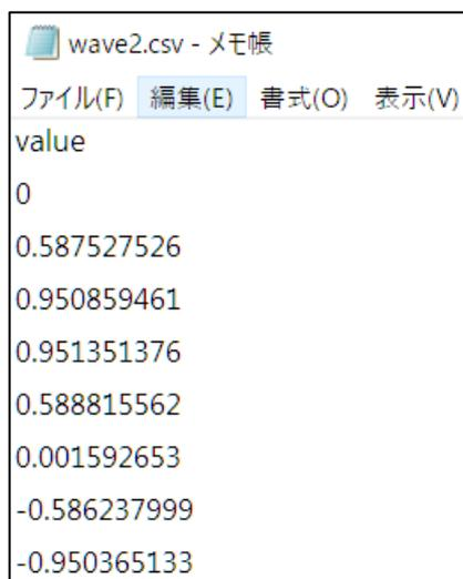
また入力の値は電圧を表していません。前提として正と負のピーク値の 2 倍を 100%として正規化されます。出力波形を入力データと合わせるためには、次のようにカンマ区切りでパラメータを入力します。
