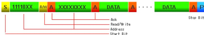
トランザクションの開始はスタートビットから始まり、ストップビットで終わります。スタートビットの状態は SCL が Hi にいる間に SDA が立下り遷移するとスタートビットです。ストップビットは SCL が Hi の間に SDA が立上がり遷移した状態です。バスを解放せずにトランザクションを続けて開始するリピータースタートコンディションはスタートビットと同じように SCL が Hi にいる間に SDA が立ち下がります。
