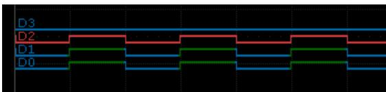
この移動で複数のラインが重なることがあります。重なった場所で調整ノブを回すと、ライン左端にどちらが選択されているかを示すボックスが表示されます。赤い文字のラインが選択状態を示します。
