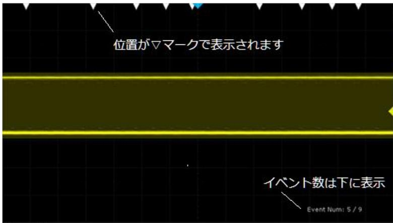
「Run/Stop」ボタンを押して、トリガを停止すると、それぞれの詳細を確認できます。Horizontal ノブを押して波形を拡大して、「Navigate」ボタンを押します。
