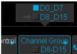
5. [System Display]ソフトキーを押すと、表示形式を Hex(16進数)、Binary(2進数)、Decimal(10進数)の中から選択できます。値はバスで選択されているデジタルラインの下位ビットから積み上げて解釈されます。
