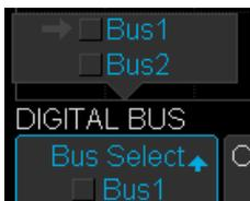
調整ノブを回して、[Bus1]または[Bus2]を選択し、調整ノブを押して有効/無効を設定します。
