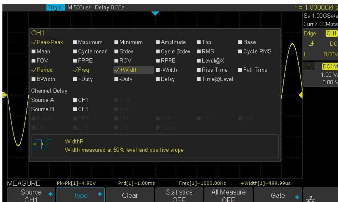
4. 測定パラメータが追加されると、「パラメータ名[ソース Ch]=値」が波形表示エリアの下に表示されます。
