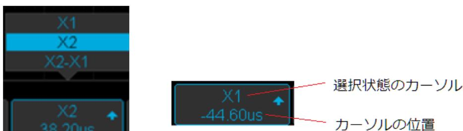
注意) カーソルの選択は必ず調整ノブを押して、確定させてください。確定前は選択メニューが表示されています。
