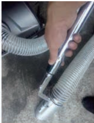
図25-1 ロックを押し開ける
