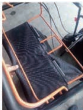
図 31-3 収集バッグを取り外す
