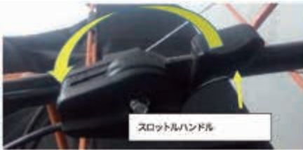
図14-1 スロットルハンドル（エンジン停止位置）
