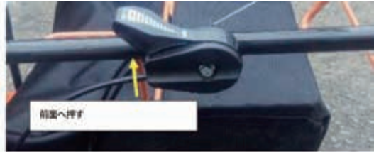
図14-2 スロットルハンドル（エンジン始動位置）
