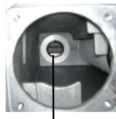
ポンプ内に張り付いたOリング
