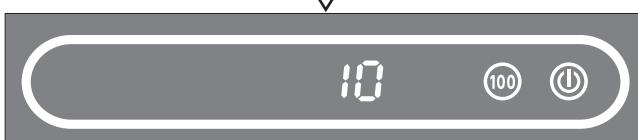
加熱中は沸騰ボタンと電源ボタンが点灯します。(上図は水温が10°Cの場合)
