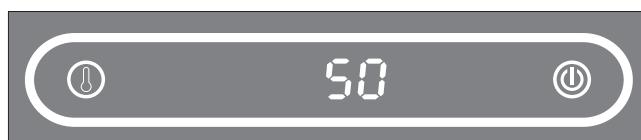
加熱中は温度設定ボタンと電源ボタンが点灯します。(上図は水温が50℃の場合)
