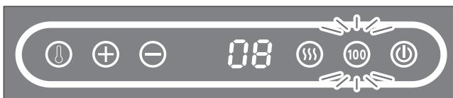
沸騰ボタンが点滅し、水温を表示します。(上図は水温が8°Cの場合)
