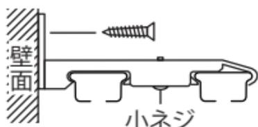
※ランナーを出し入れする場合は、レール上面よりキャップとレールの間に⊖ドライバーを差し込みキャップを少し持ち上げるようにしてはしてください。
