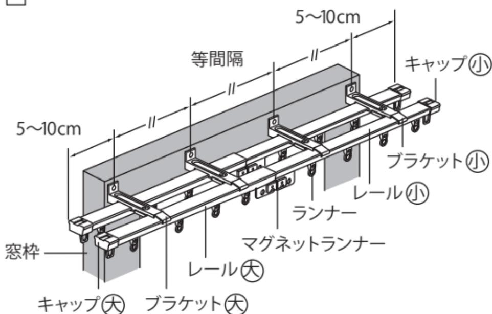
3. 付属の取付けネジでブラケットを壁面等に固定してください。
