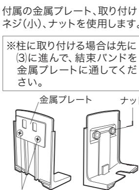
付属の金属プレート、取り付けネジ(小)、ナットを使用します。
