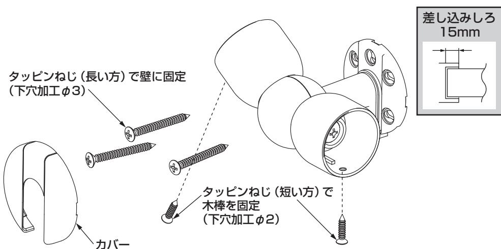
ブラケット固定ねじは必ず上側に2本、下側に1本を固定してください。手すりの角度に応じて、施工しやすい穴をお選びください。
