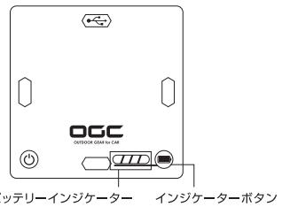
インジケーター ボタン②を押すと、バッテリーインジケーターが点灯し、残量を5段階で表示。約5秒後に消灯。
