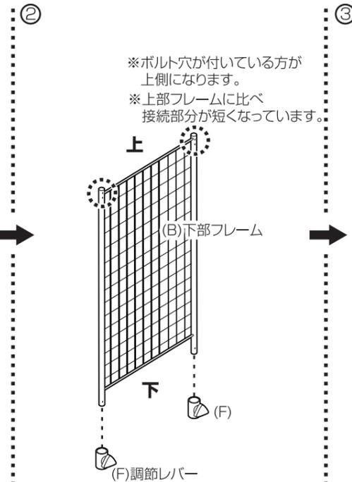
組み立てたポールを差し込んでから調節レバーを締め付けてください。
