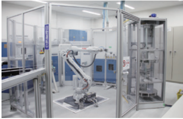
● センターラボ 各種原料を粉碎混合した後の調合原料と、キルンで焼成した後のクリンカを自動でサンプリング・分析し、セメントの化学成分が常に一定になるように24時間体制で制御しています。
