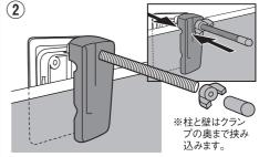
・L型ボルトの蝶ナットとネジキャップを取り、柱、壁の 間で、クランプ台を穴に通し、蝶ナットでしっかり締 めます。ネジキャップを付けてください。
