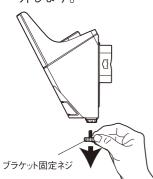
② ブラケットを下方向へスライドさせてから ブラケットを完全に外します。
