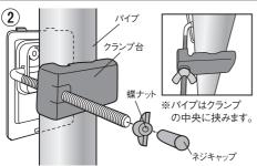
・L型ボルトの蝶ナットとネジキャップを取り、柱、パイ プの間で、クランプ台を穴に通し、蝶ナットでしっかり 締めます。ネジキャップを付けてください。
