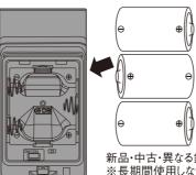
新品・中古・異なる銘柄の電池を混ぜて使用しない。 ※長期間使用しない場合は電池を外してください。 電池が液漏れします。
