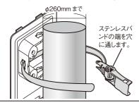
②縦向きのパイプには取り付けできますが、横向き の丸パイプに対しては、本体の重みで回転してし まう可能性があるので、取り付けないでください。
