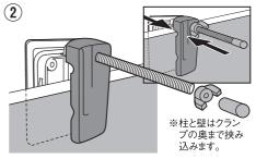
・L型ボルトの蝶ナットとネジキャップを取り、柱、壁の間で、クランプ台を穴に通し、蝶ナットでしっかり締めます。ネジキャップを付けてください。
