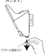
② ブラケットを下方向へスライドさせてから ブラケットを完全に外します。
