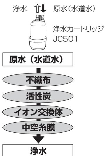
第1ろ過層(不織布)、第2ろ過層(活性炭)、第3ろ過層(イオン交換体)および第4ろ過層(中空糸膜)の4重フィルターできれいなおいしい水をつくります。
