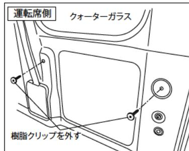
**1** 車両側面の樹脂クリップをドライバーで回して外します。(2ヶ所)
