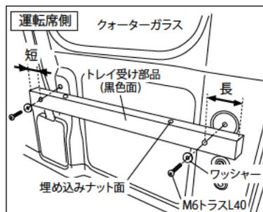
**2** トレイ受け部品を車両側に付属のネジで取り付けます。(トラス小ネジM6L40)
