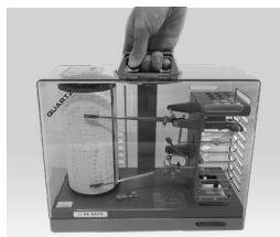
19.キャリングハンドルを右に90°回してセット完了です。
