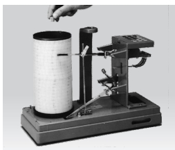
12.円筒押えネジを取り付ける。
