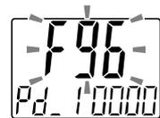
SETボタンを押します。↓ 計測プロセスデータ表示(Bit0~15)に移ります。
