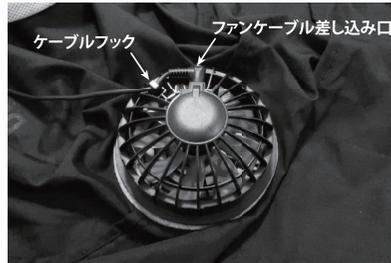
リモコン付きケーブルの赤色のプラグをバッテリーに差し込み、黒色のプラグをファン側の差し込み口に接続します。ファンカバーに付いているケーブルフックにケーブルを引っかけて固定します。
