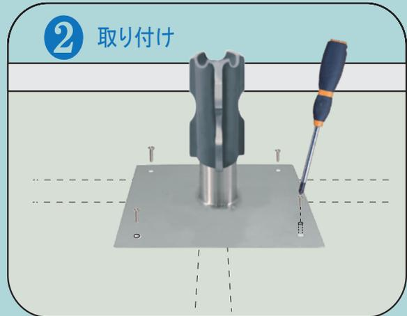
穴を開けた部分に脱気筒を合わせ、オールプラグ、ビスで固定する
