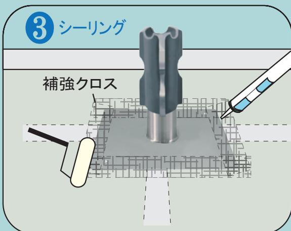
補強クロスを脱気筒の端末部に合わせて貼り、プライマーを塗布し、シーリングを段差に合わせて打つ。
