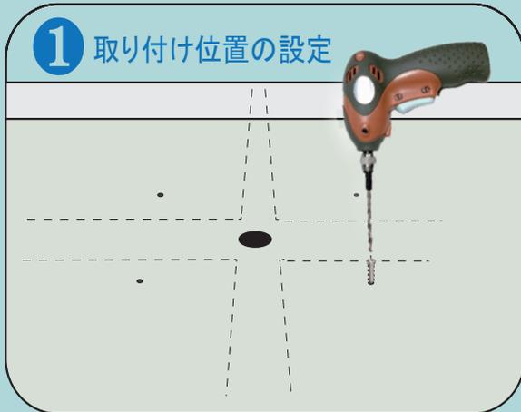
目地交差部に脱気筒の中心を合わせ印をつけ、ドリルで印を付けた部分に穴を開ける。粉塵を綺麗に除去する。
