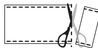
カットした生地の端は補強のため、2回折り込み、付属の結束バンドを用いて取り付けてください。
