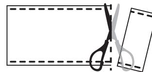
カットした生地の端は補強のため、2回折り込み、付属の結束バンドを用いて取り付けてください。
