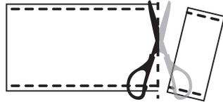
カットした生地の手端は補強のため、2回折り込み、付属の結束バンドを用いて取り付けしてください。(下記図解参照)
