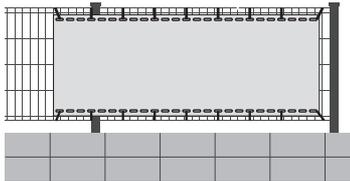
付属の結束バンドを用いてホールに等間隔で固定。目安として約30cm間隔でしっかりと取り付けてください。
