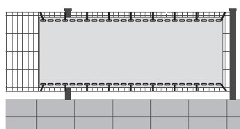
付属の結束バンドを用いてホールに等間隔で固定。自安として約30cm間隔でしっかりと取り付けてください。
